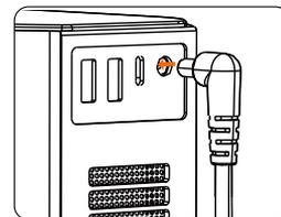
Verbinden Sie das Hauptgerät mit dem Netzanschluss
