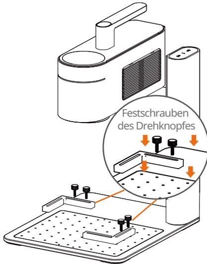
2 Positionieren Sie die Haltevorrichtung und der Einbau ist abgeschlossen.
